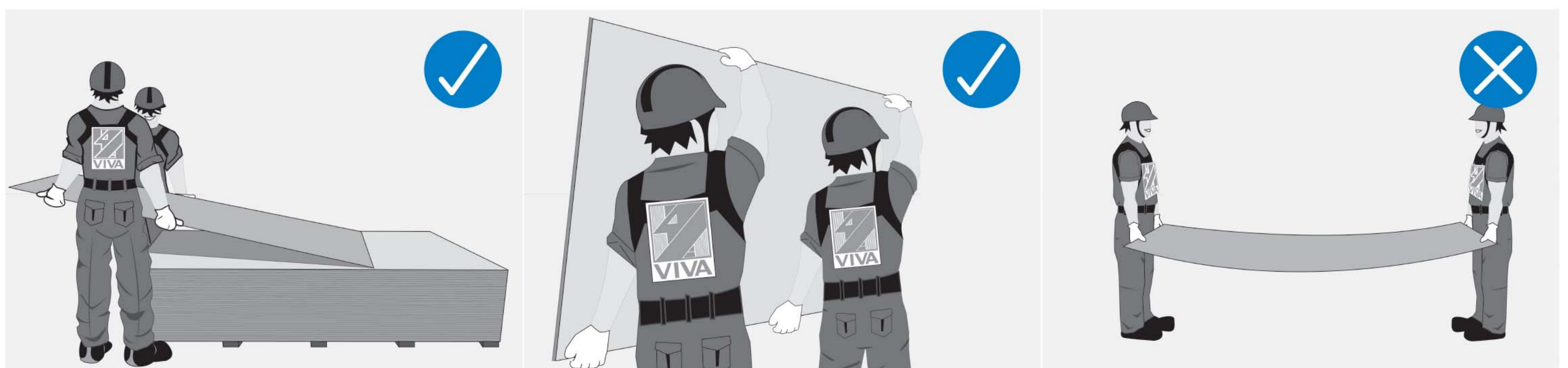
ยกแผ่นจากทางด้านข้างที่ละแผ่น
